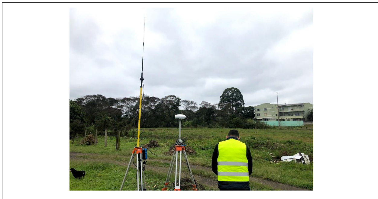
Figura 1 – Coleta de pontos de precisão com RTK em campo
