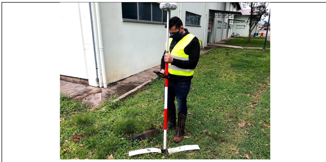
Figura 2 – Coleta de coordenadas dos pontos de controle
